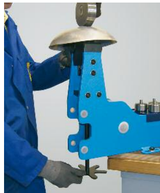
Réglage fin de la pression de travail.
