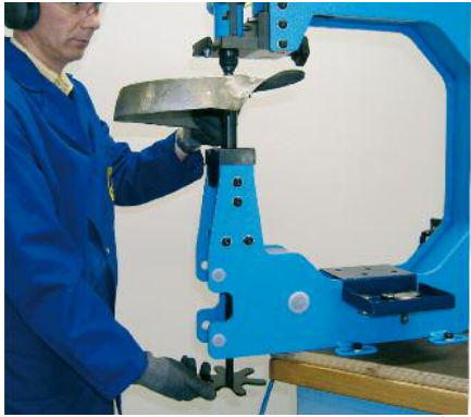
Réglage fin de la pression de travail.
