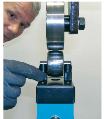
Réglage optimum des rouleaux.
