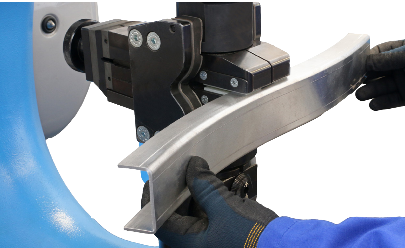
Stauen und Strecken an U-Profilen / Shrinking and stretching on U-profiles
