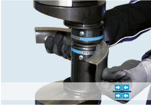
Stauchten von Blechen und Profilen / Shrinking sheet metal and profile sections
