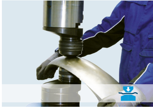
Glätten von vorgeformten Blechteilen / Planishing preformed or flat sheet blanks
